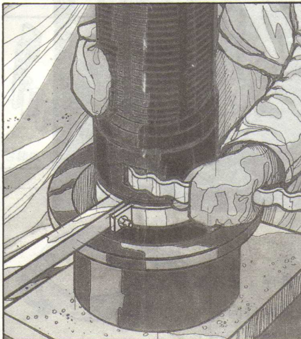
▲插口插入承口後，以鎖條鎖入鎖條溝
